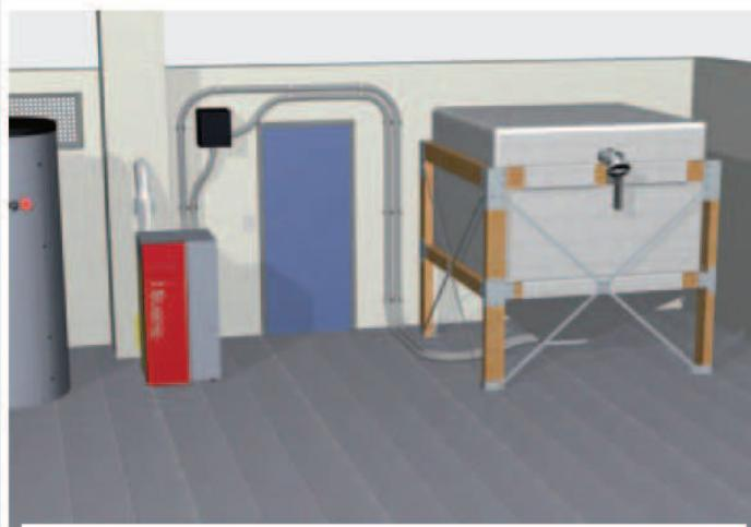
Pelety lze skladovat v uzavřených prostorách uvnitř budovy, ale efektivnější využití prostoru nabízí speciální sila na pelety.
