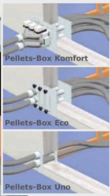
Malé rozměry pelet umožňují flexibilní automatické zásobování kotle palivem s dodávkou pelet i ze vzdáleného skladu. Pelety ze skladu do zásobníku kotle přesunuje sací systém. Pozice odsávacích sond a předávací jednotky (Pellets-Box) lze přizpůsobit libovolným podmínkám a znásobit tak prostorovou výhodu kotle Fröling PS Pellet.
