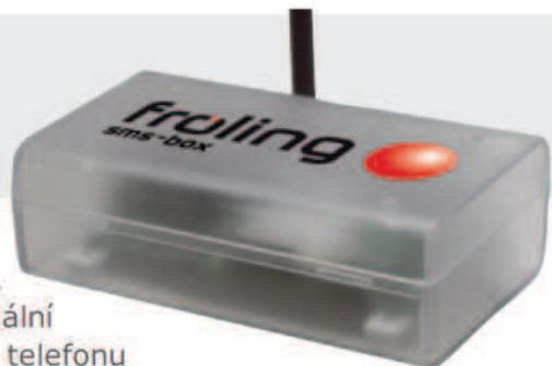
Všechny kotly s automatickým přikládáním je možné vybavit zařízením SMS-Box pro ovládání prostřednictvím mobilního telefonu. Prostřednictvím SMS zpráv kotel automaticky upozorňuje na potenciální problémy podle nastavení definovaných uživatelem. Prostřednictvím telefonu lze také kotel plnohodnotně ovládat – zapnout i odstavit kotel nebo měnit režim provozu v součinnosti s pokojovými čidly. Pro zajištění spolehlivého provozu kotel automaticky potvrzuje vykonání příkazu zasláním potvrzující SMS.
