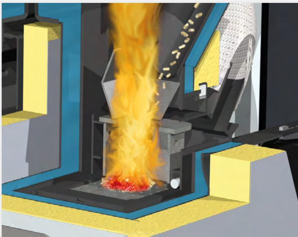
Der wassergekühlte Pelletsbrenner ist perfekt auf die Brennstoffanforderungen abgestimmt und ermöglicht besonders hohe Wirkungsgrade. Der Schieberost sorgt für eine automatische Reinigung und Entaschung in eine große Aschelade und gewährleistet so einen komfortablen und wartungsfreien Betrieb.
