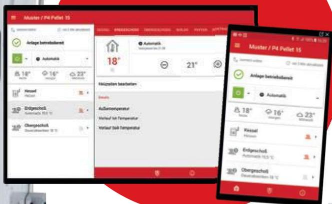
Po zprovoznění a připojení kotle s dotykovým displejem k internetu lze kotel ovládat s pomocí tabletu nebo smartphone (se systémem iOS či Android).
