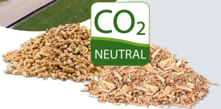
Holzpellets bestehen aus naturbelassenem Holz. Die in der Holzverarbeitenden Industrie als Nebenprodukt in großen Mengen anfallenden Hobel- und Sägespäne werden unbehandelt verdichtet und pelletiert. Durch die hohe Energiedichte und die einfache Liefer- und Lagermöglichkeit erweisen sich Pellets als der optimale Brennstoff für vollautomatische Heizanlagen. Die Lieferung der Pellets erfolgt mittels Tankwagen, von dem aus der Lagerraum direkt befüllt wird.
